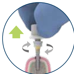
Paso 2: desacoplar el transportador plástico al tiempo que realiza el giro de inserción
